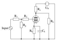
$$0 = G_2 \frac{U_{in}G_1 + U_gG_2}{G_1 + G_g + G_2} - U_gG_2 - i_g$$
